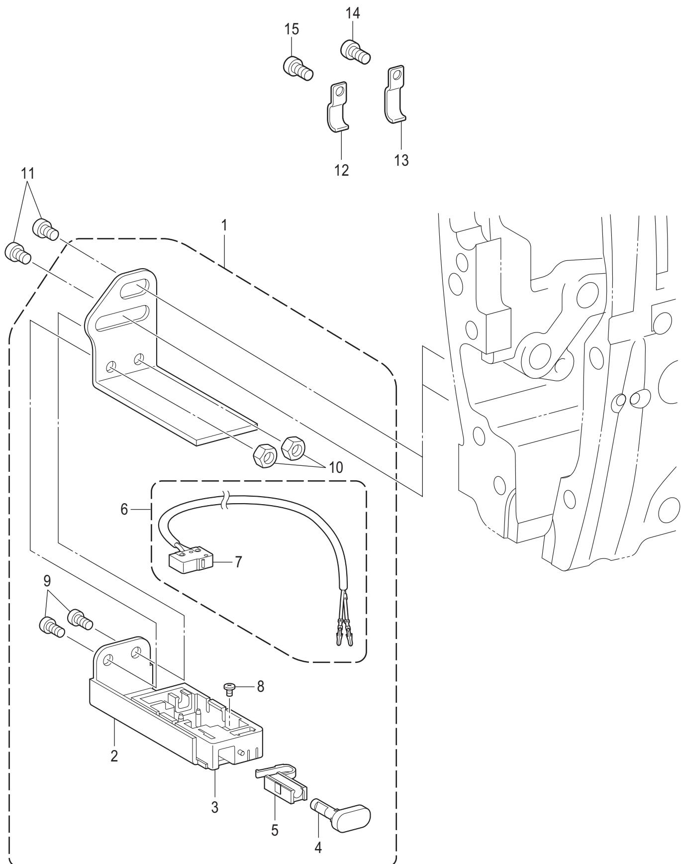
R. 逆転スイッチ関係 / Quick reverse switch mechanism
