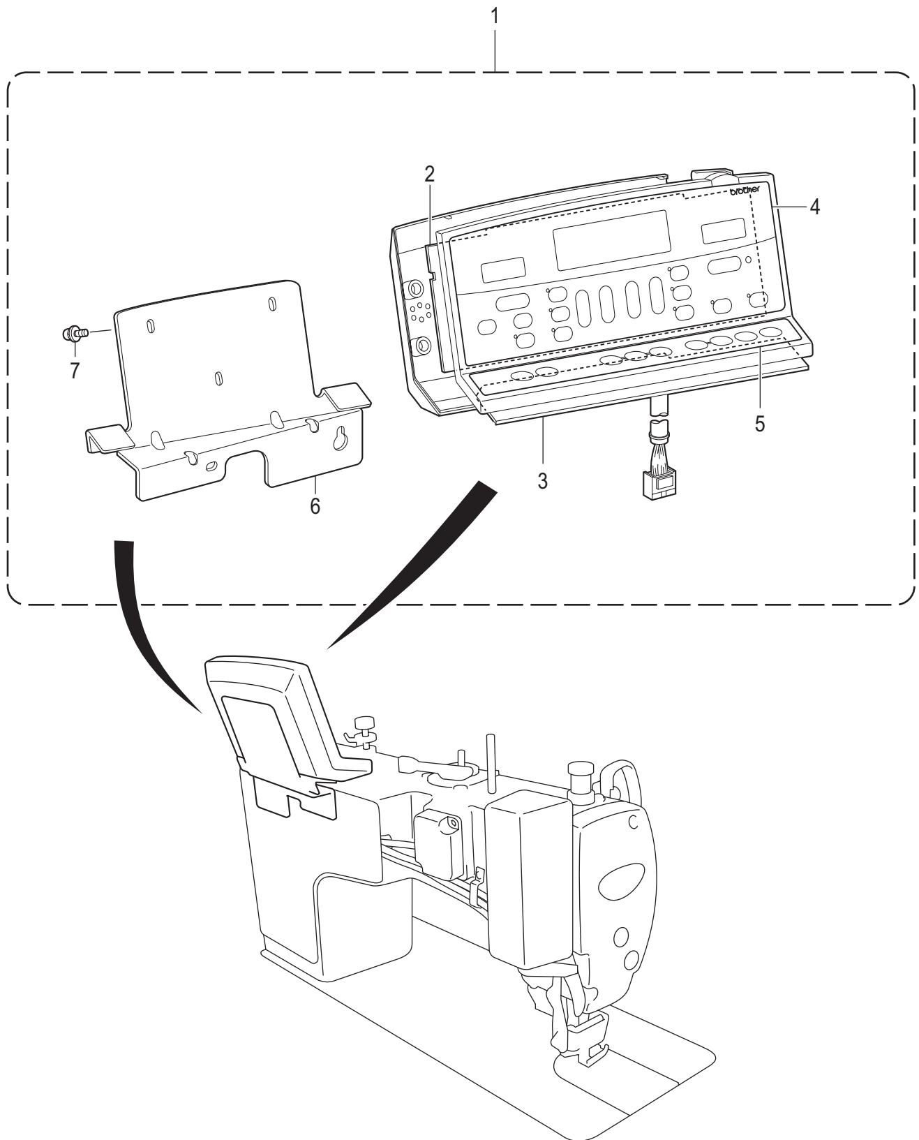
Q2 . コントロールボックス関係 / Control box mechanism
