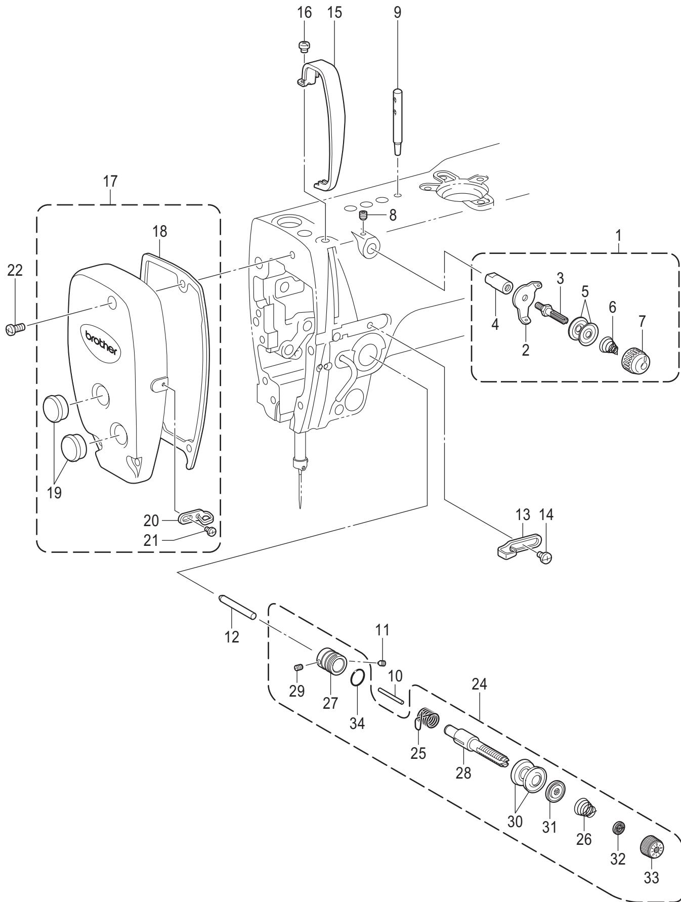
K. 糸通し関係 / Threading mechanism
