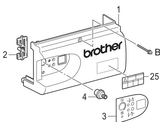
Q3 . コントロールボックス関係 / Control box mechanism
