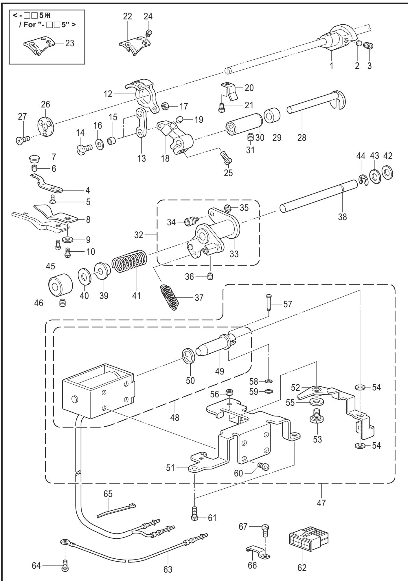
M. 糸切り関係 / Thread trimmer mechanism
