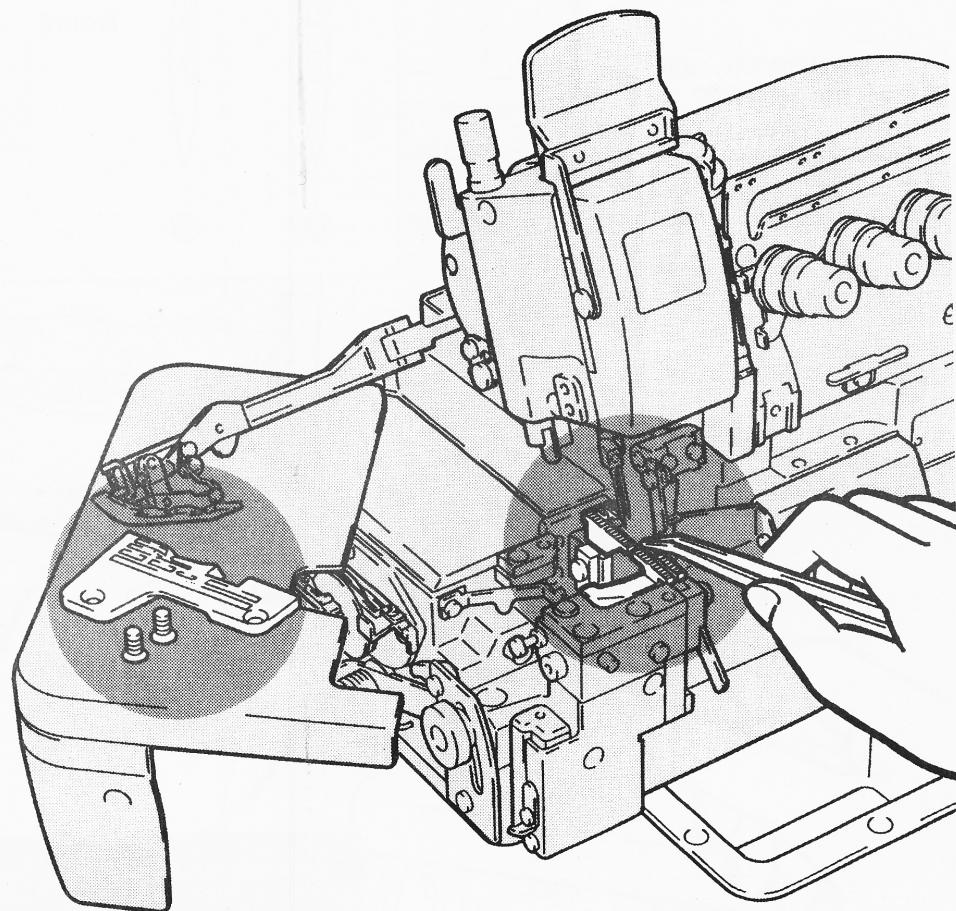
准确辨认针的前后，请将针凹向着后方，即背向操作者进行安装。
