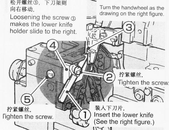
转动手轮将上刀移动对准如右图所示位置。
